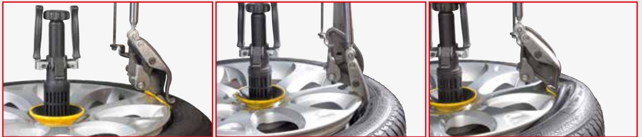
Procedimento de desmontagem do talão superior
