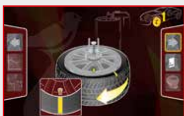
Procedimento de Match-Mounting da jante e pneu
